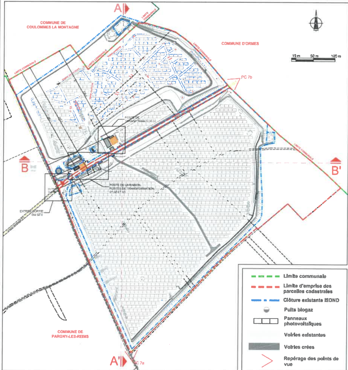
PLAN DE MASSE panneaux photovoltaïques échelle 1/2000 ème
